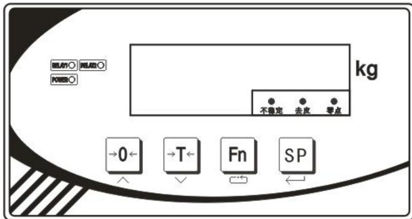
称重显示控制器显示面板上布置了四个按键，用于仪表的各种操作及参数设定。
